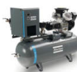
Sonderausführung: Komplette Druckluftstation mit FX-Kältetrockner sowie DD- und PD-Filtern, auf Behälter
